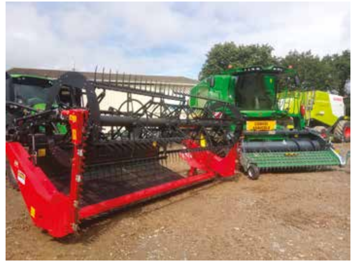
Un faucheuse andaineuse 4m50 marque Idass et un pick-up adaptable à la moissonneuse marque Idass
